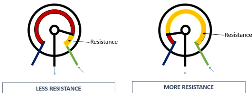
Abbildung 6 Potentiometer-Anwendung als variabler Widerstand
